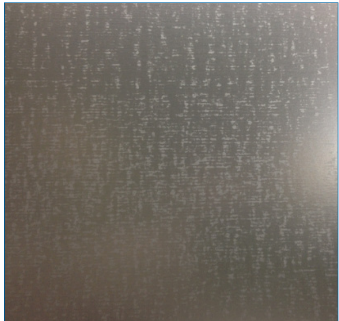
Figure 1: Le marbrage de la tôle d'acier prépeinte
